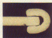
■腐食液に漬けた後の断面
